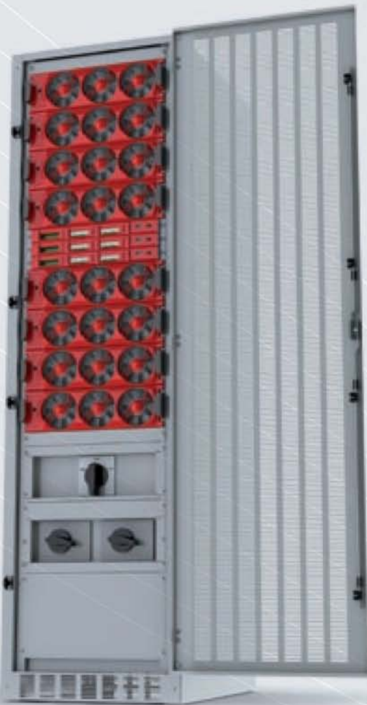
AGIL USV 160kVA (8x 20kVA) mit DC- und AC-Anschlüssen und Handumgehung; 600x800x2130mm [BxTxH]
