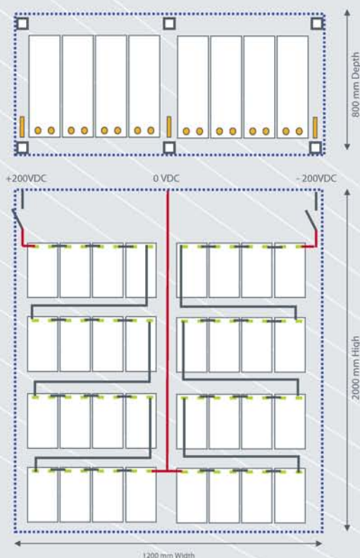
Batterianordnung mit 150-200AH Frontterminal-Batterien
